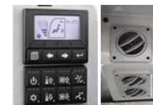
外気導入型エアコン
